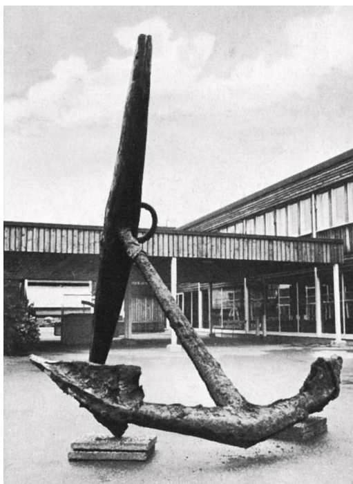
■ Один из якорей «Вазы», который вчерне был изготовлен в регионе Бергслеген, а потом прошел окончательную обработку в кузнице на Скеппхольмене
